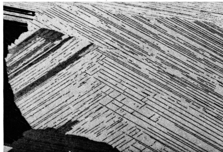
Abb. 6. Spuren von \text{Mg}_3\text{Sb}_2 -Lamellen in zwei verschiedenen Richtungen in ein und demselben Korn; 200-mal.
