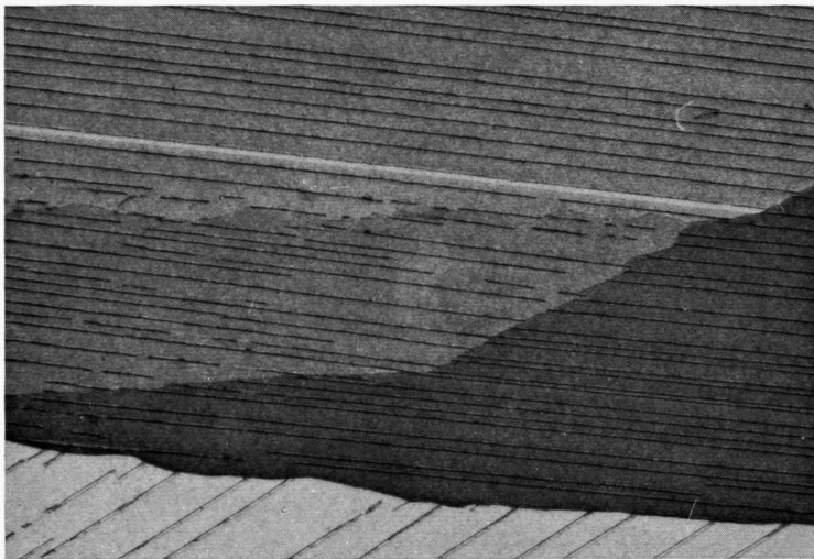
Abb. 2. Eutektisches Gefüge und nachträglich durch Ätzen in einer CuSO 4 -Lösung sichtbar gemachtes Korngefüge der InSb-Matrix; 200-mal.
